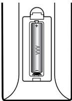
Quite la cubierta de la batería en la parte trasera del Control Remoto e inserte una batería (tamaño AAA) de 1,5 Vcc en donde **+** y **-** estén colocados correctamente.
