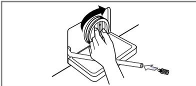
4. Tras la limpieza, coloque el filtro de la bomba e introduzca el tapón de drenaje.
