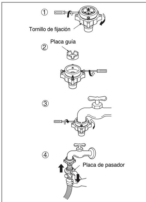
1. Retire los tornillos de la placa adaptadora de la junta y los 4 tornillos de sujeción del adaptador.
