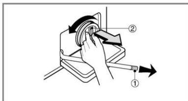
2. Desconecte el tapón de drenaje (1) dejando que el agua fluya hacia fuera. En este momento utilice un recipiente para impedir que el agua caiga al suelo. Si ya no sale agua, gire el filtro de la desagüe (2) a la izquierda hasta abrirlo totalmente.
