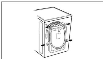
1. Para impedir los daños internos durante el transporte, los 4 tornillos especiales están bloqueados. Antes de hacer funcionar la lavadora, quite los tornillos junto con los tapones de caucho.
