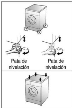
1. La nivelación correcta de una lavadora impide el ruido y la vibración excesivos. Instale el aparato sobre una superficie de suelo sólida y nivelada, preferiblemente en la esquina de una habitación.
