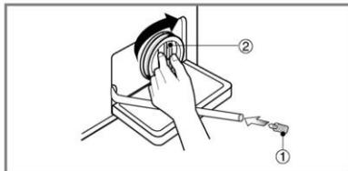
4. Después de la limpieza, gire el filtro de la desagüe (2) en el sentido de las agujas del reloj e inserte el tapón de drenaje (1) en su lugar original. Cierre el tapón de la cubierta inferior.
