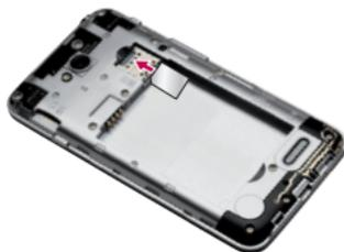
3. Inserte la batería en su lugar alineando los contactos dorados del teléfono y la batería y presione la batería hacia abajo hasta que encaje en su lugar.
