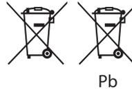
1. Ce symbole peut être associé aux symboles chimiques du mercure (Hg), du cadmium (Cd) ou du plomb (Pb) si la batterie contient plus de 0,0005% de mercure, 0,002% de cadmium ou 0,004% de plomb.
