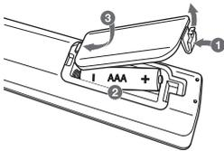
Retirez le couvercle du compartiment des piles à l'arrière de la télécommande, puis insérez deux piles R03 (AAA) en respectant la polarité  $\oplus$  et  $\ominus$ .
