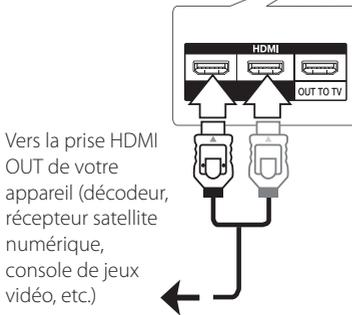
Vers la prise HDMI OUT de votre appareil (décodeur, récepteur satellite numérique, console de jeux vidéo, etc.)
