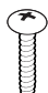
Aluse kruvid 4EA, M4 x L20 (Ainult LB65** -ZE/ZN) (Vt lk A-4, A-5)
