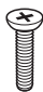
Zavrtnji za postolje 4EA, M4 x L10 (Samo za modele LB70**, LB72**, LB73**-ZD/ZE) (Pogledajte stranicu A-6)
