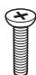
Jalustan ruuvit 4EA, M4 x L10 (Vain LB70**, LB72**, LB73**-ZD/ZE) (Katso sivua A-6)
