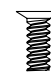
Vis du support 4EA, M4 x L10 (Uniquement EA88**-ZA) (voir p. A-3)
