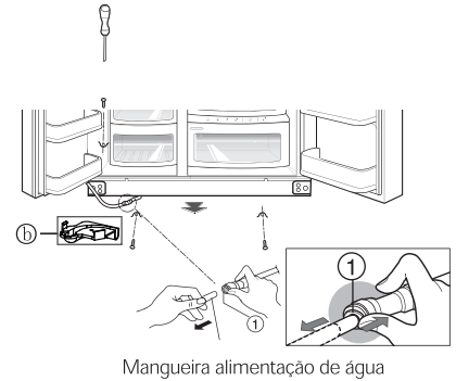
Mangueira alimentação de água
