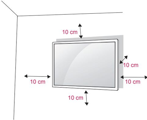
Si tiene intención de montar el monitor en la pared, fije el accesorio de montaje en pared (piezas opcionales) a la parte posterior del monitor. Si instala el monitor mediante el accesorio de montaje en pared (piezas opcionales), fíjelo con cuidado para que no se caiga.
