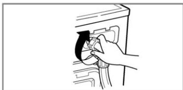
4. Resserrer le tuyau d'arrivée d'eau.
