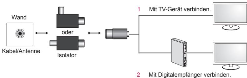
Verbinden Sie ein Ende des Isolators mit der Kabel-/Antennenbuchse und das andere Ende mit dem TV-Gerät oder dem Digitaempfänger.
