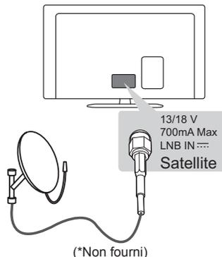
Connectez la TV à une parabole satellite ou à une prise satellite à l'aide d'un câble satellite RF (75 Ω).
