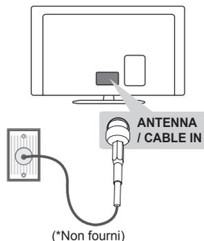
Connectez la TV à une prise d'antenne murale avec un câble RF (75 Ω).
