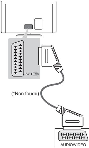
Transmet les signaux audio et vidéo d'un appareil externe au téléviseur. Raccordez l'appareil externe et le téléviseur à l'aide d'un câble périTel comme illustré ci-dessous.
