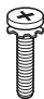
Stovo varžtai 8EA, M4 x L20 (Tik UB83**-ZB) (Žiūrėkite A-4) 4EA, M4 x L20 (Tik UB80**, UB82**) (Žiūrėkite A-3)
