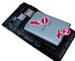
4. Alinee la tapa posterior sobre el compartimiento de la batería ❶ y presione hacia abajo hasta que encaje en su lugar ❷.
