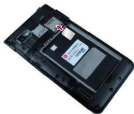
3. Inserte la batería en su lugar alineando los contactos dorados del teléfono y la batería **1** y presione la batería hacia abajo hasta que encaje en su lugar **2**.
