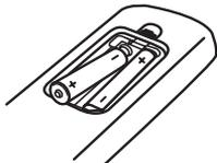
Quite la cubierta de las baterías en la parte posterior del control remoto, e inserte dos baterías (tamaño AAA) de 1,5 Vcc forma que  $+$  y  $-$  se ajusten correctamente.
