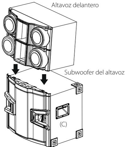
3. El PIE (A) del SPK (altavoz) DELANTERO se monta en la parte superior del orificio de guía (B) del SPK (altavoz) SWF (subwoofer).
