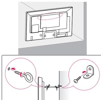
1. Insérez et serrez les boulons à œil ou les supports et les boulons à l'arrière du moniteur.
