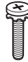
Viti del supporto 8EA, M4 x L20 (Solo UB85**-ZA, UB93**, UB95**-ZA) 4EA, M4 x L20 (Solo UB85**-ZD, UB95**-ZB, UC97**) (Vedere pag. A-3, A-4, A-8)
