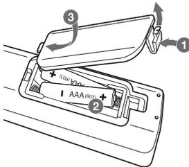
Nehmen Sie die Batterieklappe von der Rückseite der Fernbedienung ab, und legen Sie zwei Batterien (Größe AAA) mit der richtigen Polung  $+$  und  $-$  ein
