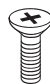
Винты для подставки 4шт, М4 x L10 (Только для UB85**-ZD, UB95**-ZB, UC97**) (См. стр. А-4, А-7)
