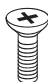
Vis du support 4EA, M4 x L10 (Uniquement UB85**-ZD, UB95**-ZB, UC97**) (voir p. A-4, A-7)
