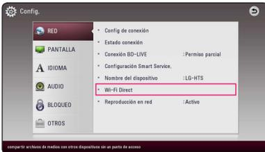
5. Seleccione un dispositivo Wi-Fi Direct™ de la lista, utilizando  $\wedge / \vee$  y presione ENTER (Ⓞ).
