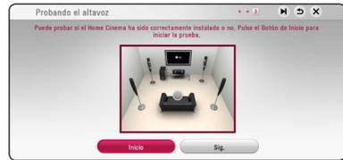
Tras comprobar las señales de tono, pulse ENTER (⊙) cuando se seleccione [Stop]. Seleccione [Sig.] y pulse ENTER (⊙).
