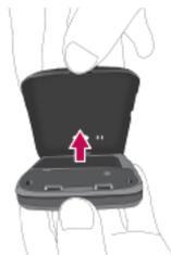
2. Alinee los contactos de la batería con los terminales del teléfono en la parte superior del compartimento.
