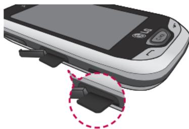
2. Inserte la tarjeta microSD™ (vendida por separada) con el logo orientado hacia arriba hasta que encaje en la ranura.
