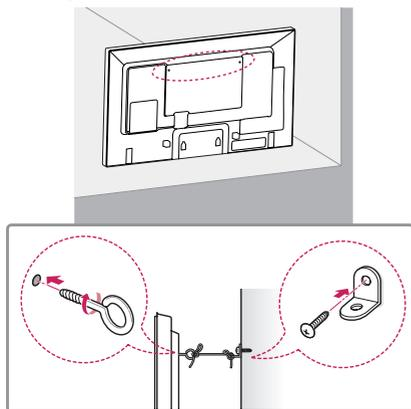
1. Introduza e aperte os parafusos com olhal ou os suportes e parafusos na parte posterior do monitor.
