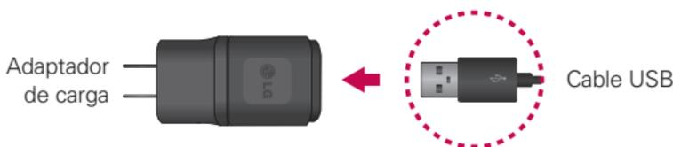
2. Inserte el otro extremo del cable USB dentro del Puerto de carga/USB.
