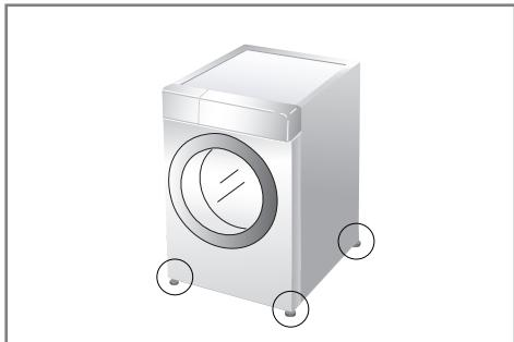
1. Undvik onödig hög ljudnivå och vibrationer genom att installera tvättmaskinen på ett plant golv, helst i ett hörn av rummet.
