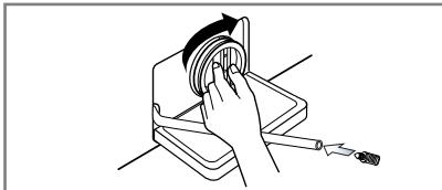
4. Efter rengöringen ska pumpfiltret vridas fast på nytt och tömningspluggen sättas tillbaks på avloppsslangen.
