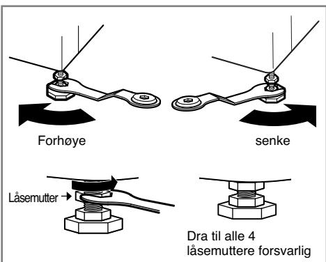
2. Juster bena på maskinen hvis gulvet er skjevt (ikke sett trestykker o.l. under bena). Kontroller at alle fire bena står stabilt og hviler på gulvet, og kontroller at vaskemaskinen står stabilt (bruk vater).
