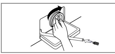
4. Efter rengøring af pumpens filter, drejes det atter på plads og bund-propnen sættes i igen.
