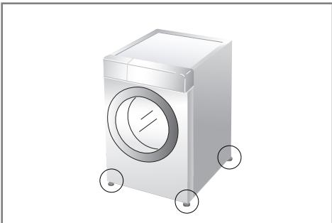
1. For å unngå støy og vibrasjoner må vaskemaskinen plasseres på et fast og jevnt underlag, helst i et hjørne.
