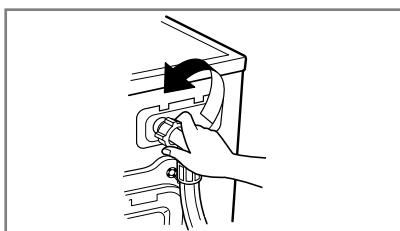
2. Skruva loss vattenslangen.
