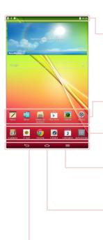
Barra de estado - Muestra información sobre el estado del dispositivo, incluidos la hora, potencia de la señal Wi-Fi, estado de la batería e iconos de notificación.
