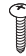
Винты для подставки 3шт, P5 x 25 4шт, M4 x 14 (Только для LN54/53**) (см. стр. A-4)
