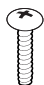
Parafusos do suporte 4 de cada, M4 x L20 (Apenas LB63** -ZU, LB65** - ZE/ZN) (Consulte a p A-4, A-5)
