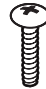
Schroeven van standaard 2 EA, M4 x L16 (Alleen 29MT40*, 29MT45*) (Zie pag.11, 13)
