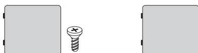
Kryt portu AV / Šroub 1EA, M3 x L8 (Pouze 98UB98**) (viz str. A-11)
