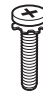
Wkręty podstawy 8Szt. M4 x L20 (Tylko modele UB85**- ZA, UB93**, UB95**-ZA) 4Szt. M4 x L20 (Tylko modele UB85**- ZD, UB95**-ZB, UC97**) (Patrz str. A-3, A-4, A-8)
