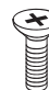
Vijci za postoljes 2EA, M4 X L10 (Samo modeli UG88**) (Pogledajte str. A-8)
