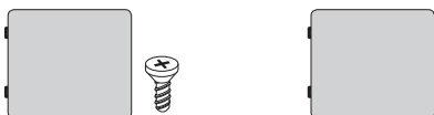
AV pordi kate / Kruvi 1EA, M3 x L8 (Ainult 98UB98**) (Vt lk A-11)
