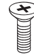
Schroeven van standaard 4EA, M4 x L10 (Alleen UB85**-ZD, UB95**-ZB, UC97**) (Zie pag. A-4, A-7)
