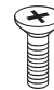
Schroeven van standaard 2EA, M4 X L10 (Alleen UG88**) (Zie pag. A-8)
