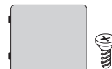
Tampa da porta AV / Parafuso 1de cada, M3 x L8 (Apenas 98UB98**) (Consulte a p. A-11)
