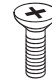
Tornillos del soporte 4EA, M4 x L10 (Solo UB85**-ZD, UB95**-ZB, UC97**) 2EA, M4 X L10 (Solo UG88**) (Consulte la página A-4, A-7, A-8)
