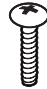
Wkręty podstawy 2 szt., M4 x L16 (Tylko modele 29MT40*, 29MT45*) (Zobacz str.11, 13)
