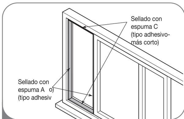
**1** Corte la espuma A (tipo adhesivo) y C (tipo adhesivo-más corto) según la longitud adecuada, y colóquelo en la hoja y el marco de la ventana.
