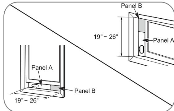
Para las aberturas de la ventana a partir de 19" a 26" el panel del respiradero de la ventana (artesonado A) y un panel del extencion (panel B). Fig. "b"
