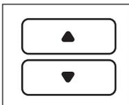
Cuando se elige la función **TIMER** (temporizador), utilice los botones **TEMP/TIMER ▲ / ▼** (temperatura/temporizador) para ajustar el tiempo de demora de 1 a 24 horas, en incrementos de una hora.
