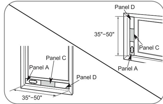
Para las aberturas de la ventana a partir del 35" a 50", utilice el panel del respiradero de la ventana y dos paneles de la extensión (el panel C y artesona D). Fig. "d"
