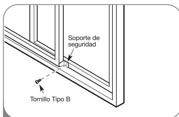
**4** Instale el soporte de seguridad con un tornillo tipo B, como puede verse.
