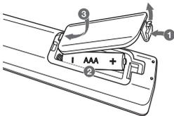
Nehmen Sie die Batterieklappe von der Rückseite der Fernbedienung ab und legen Sie zwei R03-Batterien (Größe AAA) mit der richtigen Polung **+** und **-** ein.
