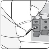
Verbinden Sie ein Woofer-Kabel mit dem Player. Stecken Sie das Woofer-Kabel in den Player, bis ein Klickgeräusch zu hören ist.
