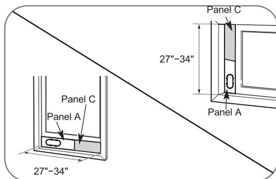
Para las aberturas de la ventana a partir de 27" a 34", utilice el panel del respiradero de la ventana (artesonado A) y un panel de la extensión (panel C). Fig. "c"
