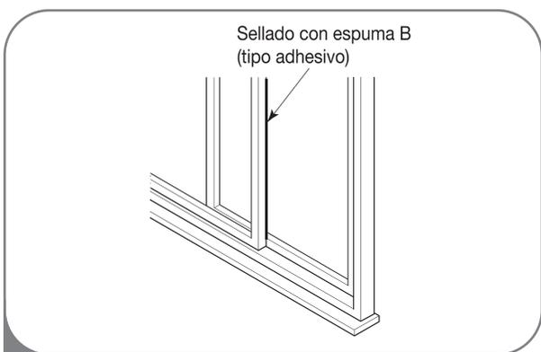
**3** Corte la espuma B (tipo no adhesivo) según el ancho de la ventana. Rellene con la espuma B la separación existente entre el cristal y la ventana a fin de prevenir la entrada de aire o insectos en la habitación.
