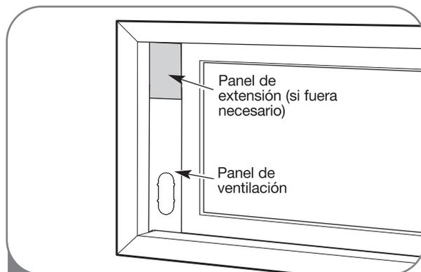
**2** Introduzca el montaje de panel de ventilación, incluyendo los paneles de extensión, si fueran necesarios, en la abertura de la ventana. Extienda los paneles de extensión, si los está utilizando.
