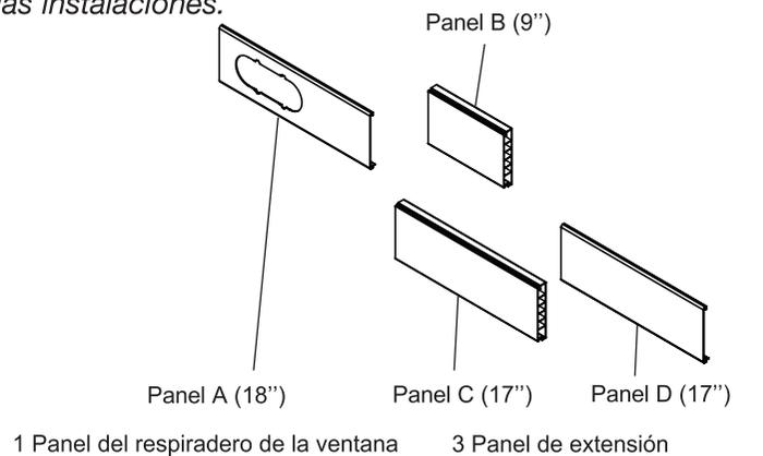
Equipo de instalación en ventanas (incluye 1 panel de ventilación para ventanas y 3 paneles de extensión)
