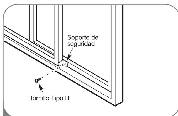
**4** Instale el soporte de seguridad con un tornillo tipo B, como puede verse.
