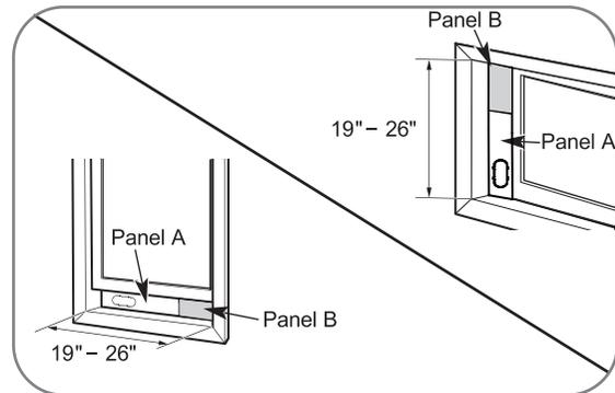
Para las aberturas de la ventana a partir de 19" a 26" el panel del respiradero de la ventana (artesonado A) y un panel del extention (panel B). Fig. "b"
