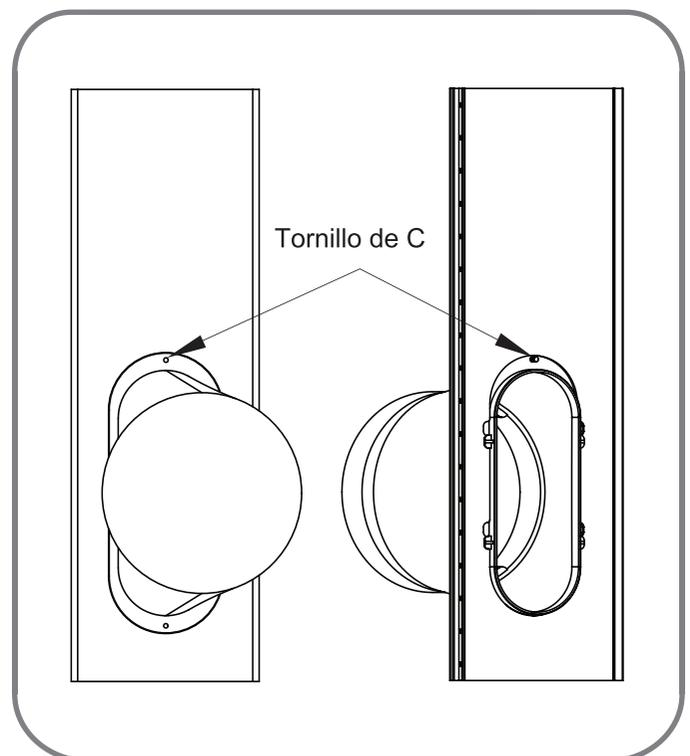
Si usted desea arreglo el difusor más firmemente, utilice el tipo tornillo de C.
