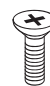
Vis du support 4EA, M4 x L10 (Uniquement UB85**- ZD, UB95**-ZB, UC97**) 2EA, M4 X L10 (Uniquement UG88**) (voir p. A-4, A-7, A-8)
