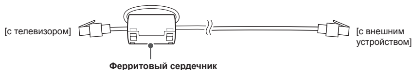
[Вид ферритового сердечника в разрезе]
