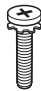
Állvány csavarja 4DB, M4 x L21 (Csak UB83**-ZG) (Lásd a A-3 oldalt)
