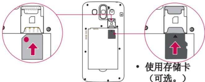
**备注：**如果要使用存储卡，请将存储卡插入上插槽。确保金色接触区域朝下面向屏幕。
