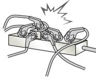
لا تقم بتوصيل الكثير من الأجهزة الكهربائية بمصدر كهربائي واحد متعدد المنافذ. وإلا فقد يتسبب ذلك في نشوب حريق بسبب السخونة الزائدة.
