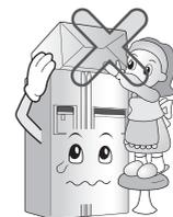
**N'installez pas le réfrigérateur dans un endroit humide ou susceptible d'éclaboussures d'eau ou de pluie.**
