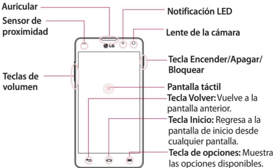
**NOTA:** Cuando reciba o realice llamadas, el sensor de proximidad apagará automáticamente la luz de fondo y bloqueará la pantalla táctil al detectar cuando el teléfono está cerca del oído. Esto aumenta la vida útil de la batería y evita que active accidentalmente la pantalla táctil durante las llamadas.
