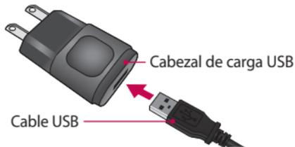
**NOTA:** Antes de conectar el cargador, asegúrese de que la batería esté instalada. Si la batería no está instalada y conecta el cargador de pared, el teléfono no funcionará adecuadamente debido a un ciclo de energía prolongado. Además, extraer la batería con el cargador conectado podría dañar al dispositivo. Desconecte el cargador antes de extraer la batería.
