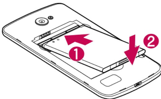
**4** Para colocar de nuevo la tapa en el dispositivo, alinee la tapa posterior con el compartimento de la batería **1** y presiónela hasta que encaje en su sitio **2**.
