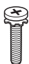
Tayanch burama mixlari 8 ta, M4 x L20 (Faqat UB83**-ZB) (A-4-sahifalarga qarang) 4 ta, M4 x L20 (Faqat UB80**, UB82**) (A-3-sahifalarga qarang)
