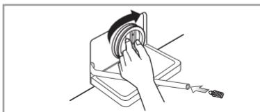
4. Após a limpeza do filtro da bomba recolocá-lo girando para a direita. Recolocar a tampa protetora da mangueira. Prender a mangueira.
