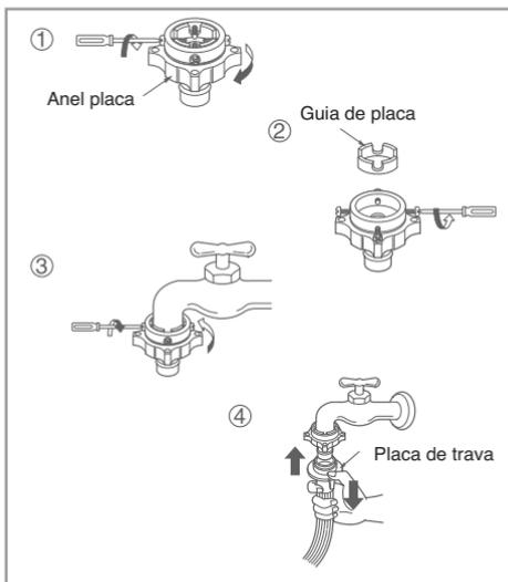
1. Desaperte o anel adaptador e os 4 parafusos adaptáveis de segurança.
