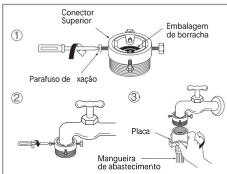
1. Desaperte o anel adaptador e os 4 parafusos adaptáveis de segurança.
