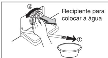
2. Utilizar um recipiente com capacidade superior a 500ml para depositar a água que será retirada do filtro da bomba de drenagem. Retirar a tampa protetora localizada na ponta da mangueira de escoamento. Aguardar até que seja retirada toda a água do filtro da bomba de drenagem. Então abra o filtro girando para a esquerda.
