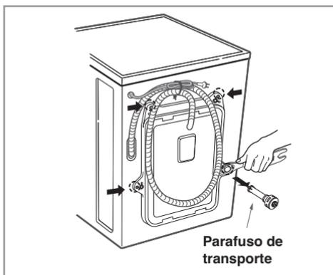
1. Desparafuse os 4 parafusos com a chave fornecida.
