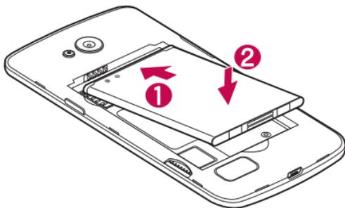
**4** Para colocar de nuevo la tapa en el dispositivo, alinee la tapa posterior con el compartimiento de la batería **1** y presiónela hasta que encaje en su sitio **2**.
