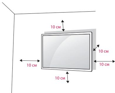
Чтобы установить монитор на стену, прикрепите кронштейн для настенного крепления (дополнительная деталь) к задней части монитора.
