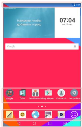
**Строка состояния** – показывает информацию о состоянии устройства, включая время, уровень сигнала Wi-Fi, заряд аккумулятора и значки уведомлений.
