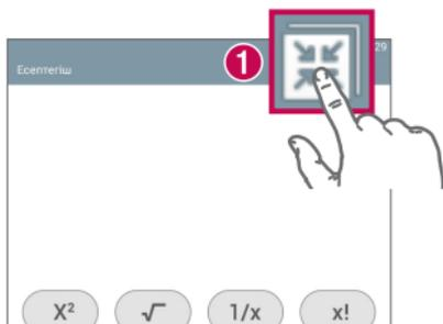
QSlide функциясына қолдау көрсететін қолданбаны пайдаланған кезде
