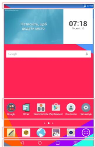
**Рядок стану:** відображення інформації про стан пристрою, зокрема час, потужність сигналу Wi-Fi, стан акумулятора та піктограм сповіщень.
